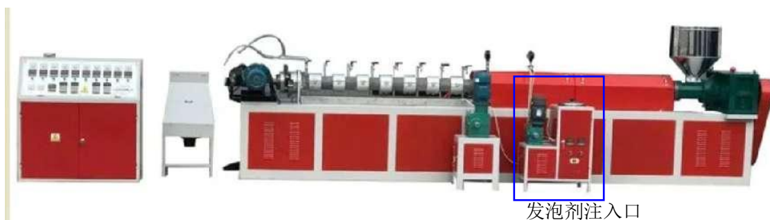
图 2-8 发泡剂注入单元示意图
