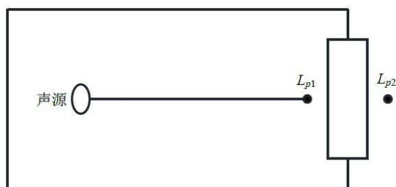
图 7.3-1 室内声源等效为室外声源图例
