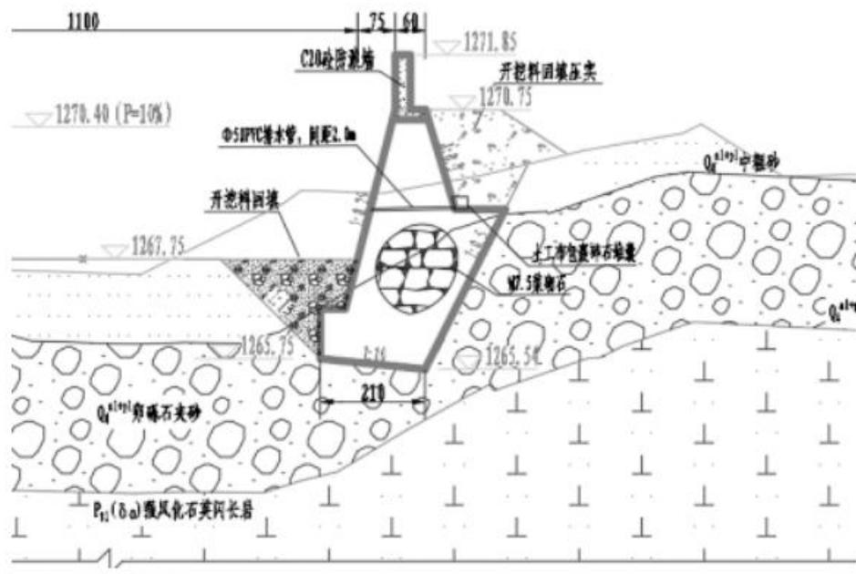
图 2-1 浆砌石衡重式防洪墙典型断面图
