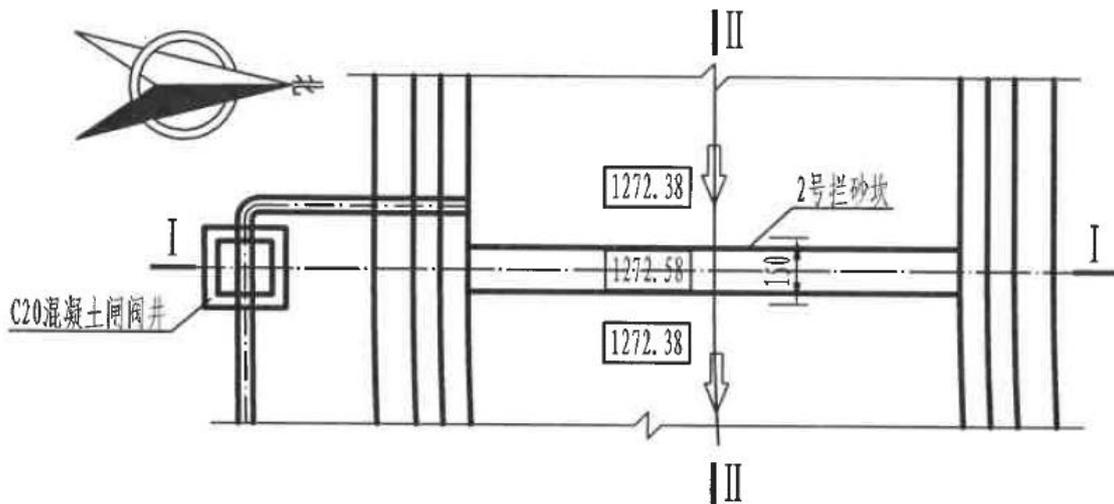
图 2-4 2 号拦沙坝平面图
