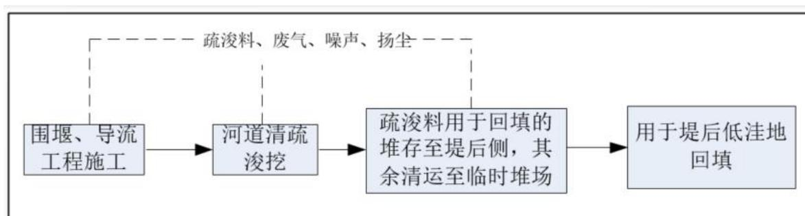
图 2-5 疏浚工艺流程及产污环节图
