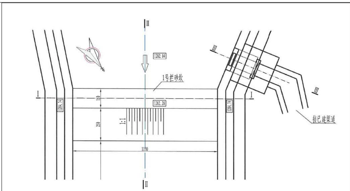
图 2-2 1 号拦砂坝平面图
