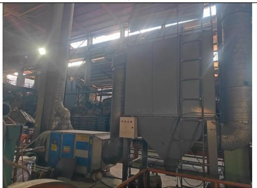
布袋除尘器+有机废气处理装置
