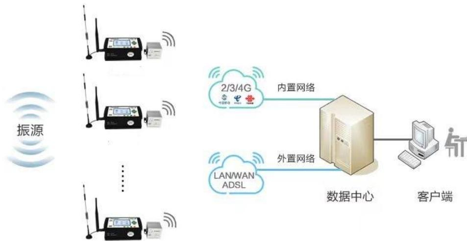
图 3.3-3 无线网络振动监测工作原理
