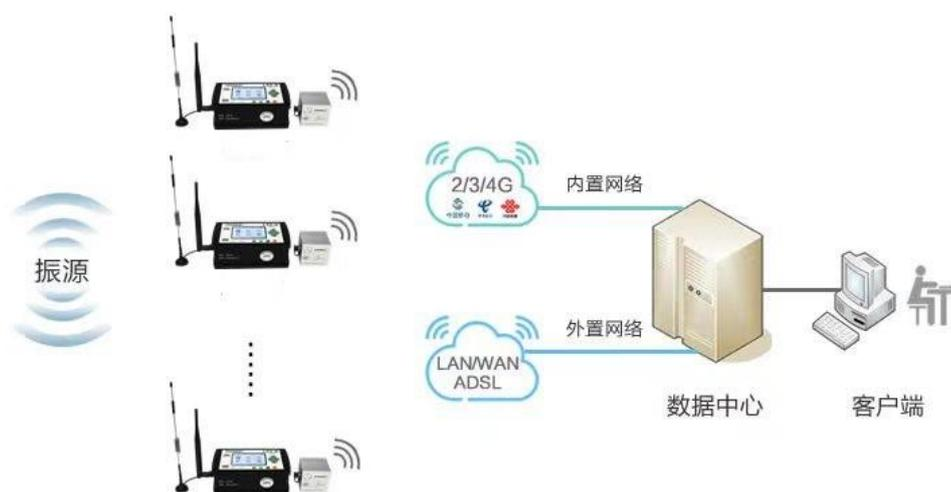
图 10.7-2 无线网络振动监测工作原理
