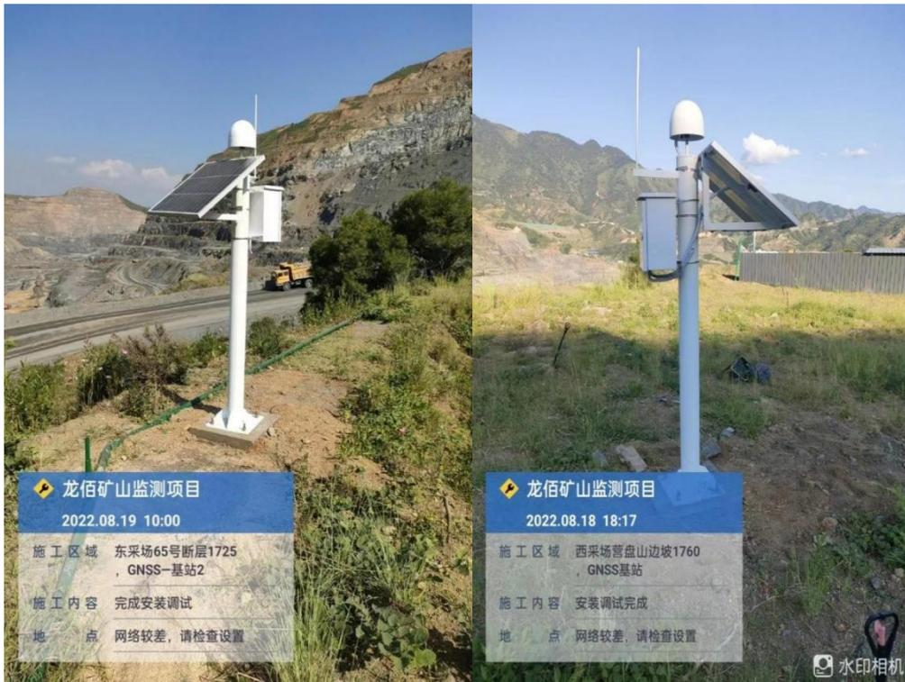
图 2.4-9 表面位移基准站现场照片
