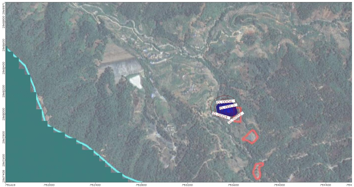
铜精矿浓缩池泄漏后 1000d 周围石油类浓度分布情况 (mg/L)
