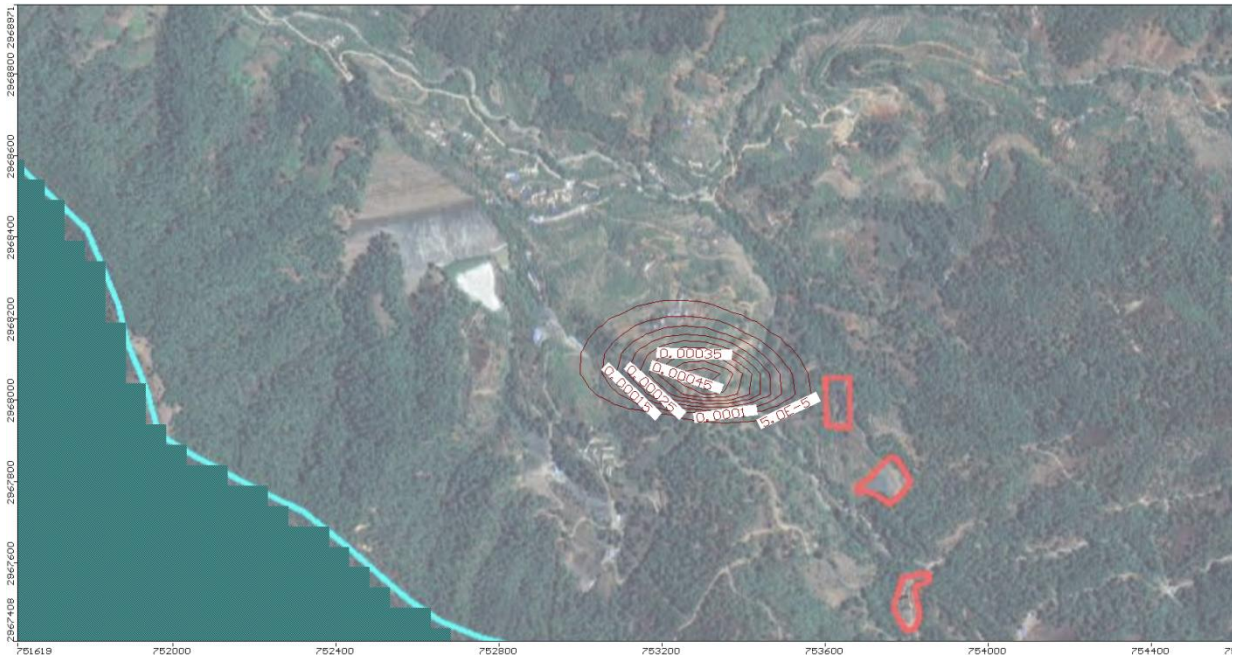
铜精矿浓缩池泄漏后 10a 周围石油类浓度分布情况 (mg/L)
