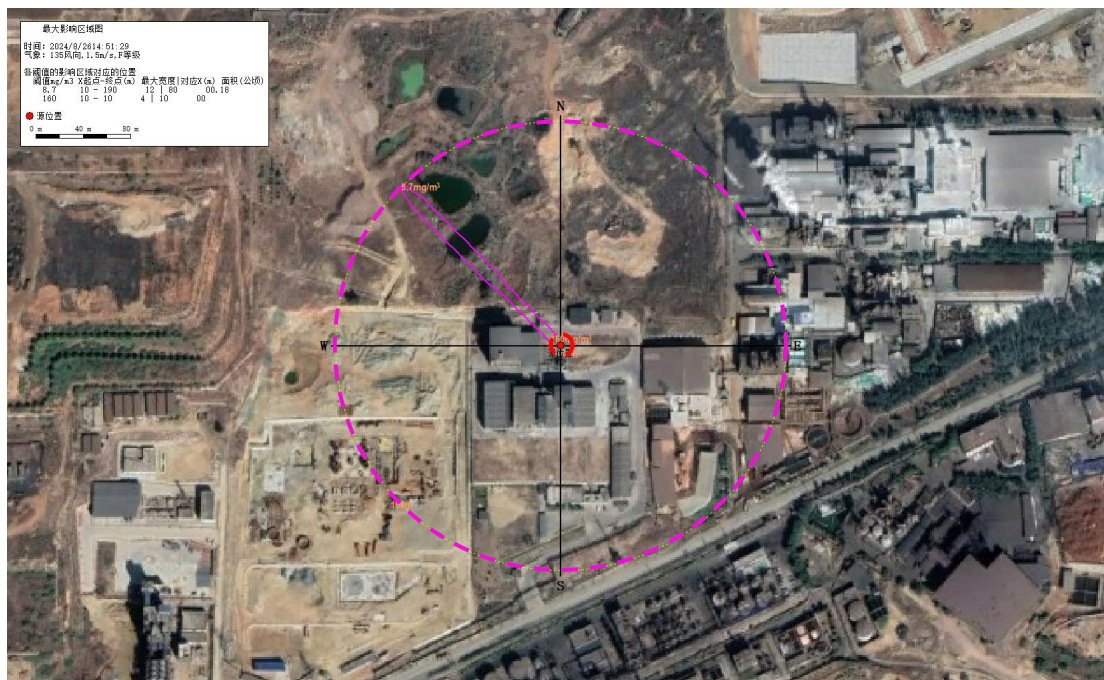
图 4.9-5 硫酸输送管道全管径泄漏影响预测图
