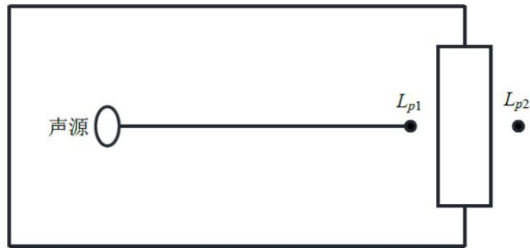
图 4-2 室内声源等效为室外声源图例
