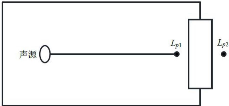
图 4-3 室内声源等效为室外声源图例
