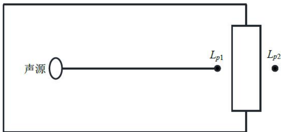
图 4-3 室内声源等效为室外声源图例
