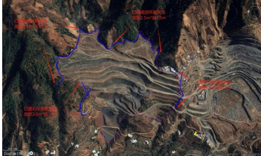
排土场已建排洪设施图
