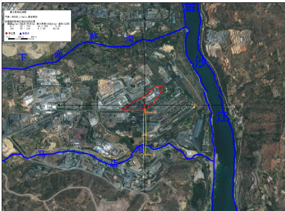
图 3-2 30%废酸池泄漏最不利气象条件下硫酸泄漏最大影响区域图
