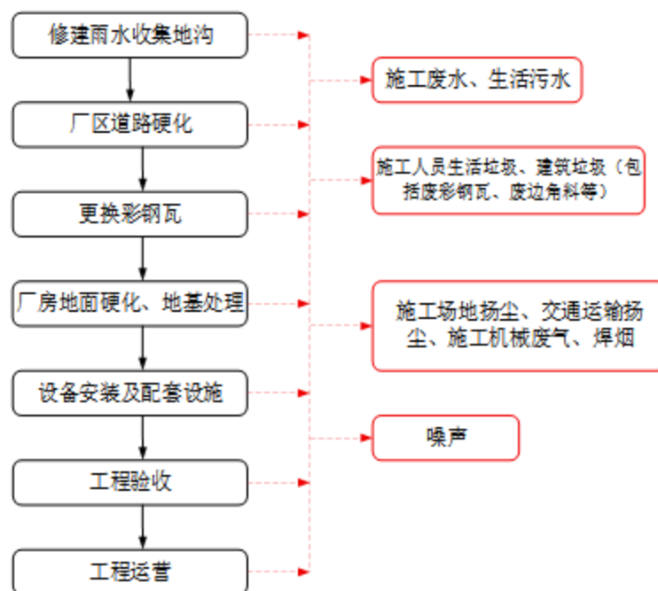
图 2-2 施工期工艺流程及产污环节图
