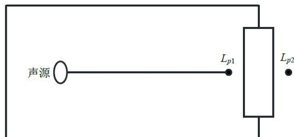
图 7.3-1 室内声源等效为室外声源图例
