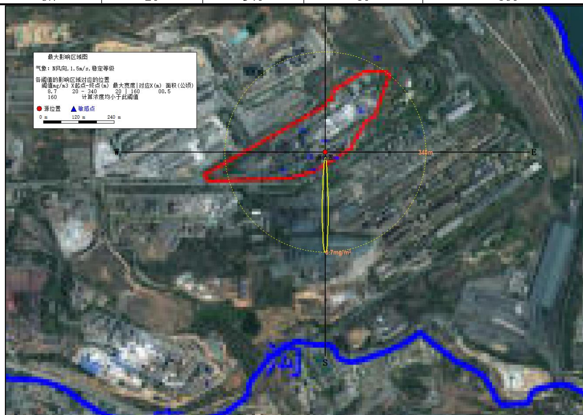
图 3-2 23%废酸池泄漏最不利气象条件下硫酸泄漏最大影响区域图
