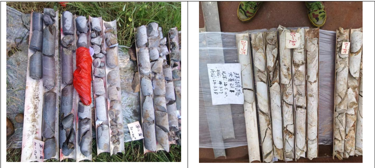
图 2-12 大箐沟特大桥的部分岩芯照片
